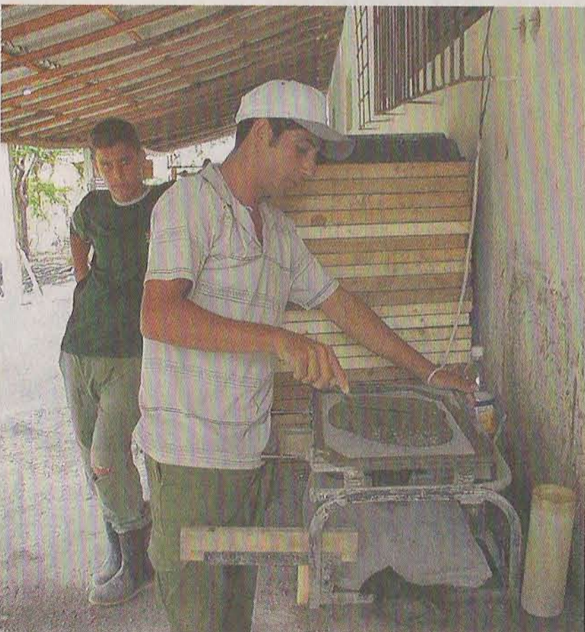
Dachziegel aus Leichtbeton: Die nicht zu brennenden Ziegel können einfach und vor Ort produziert werden.
