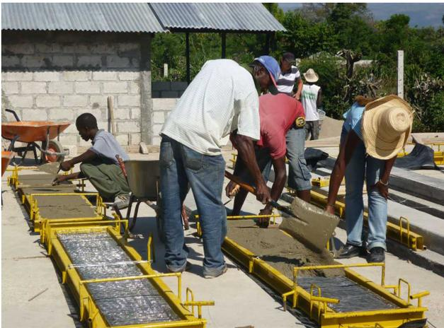
Ferrozement-Platten werden manuell hergestellt
